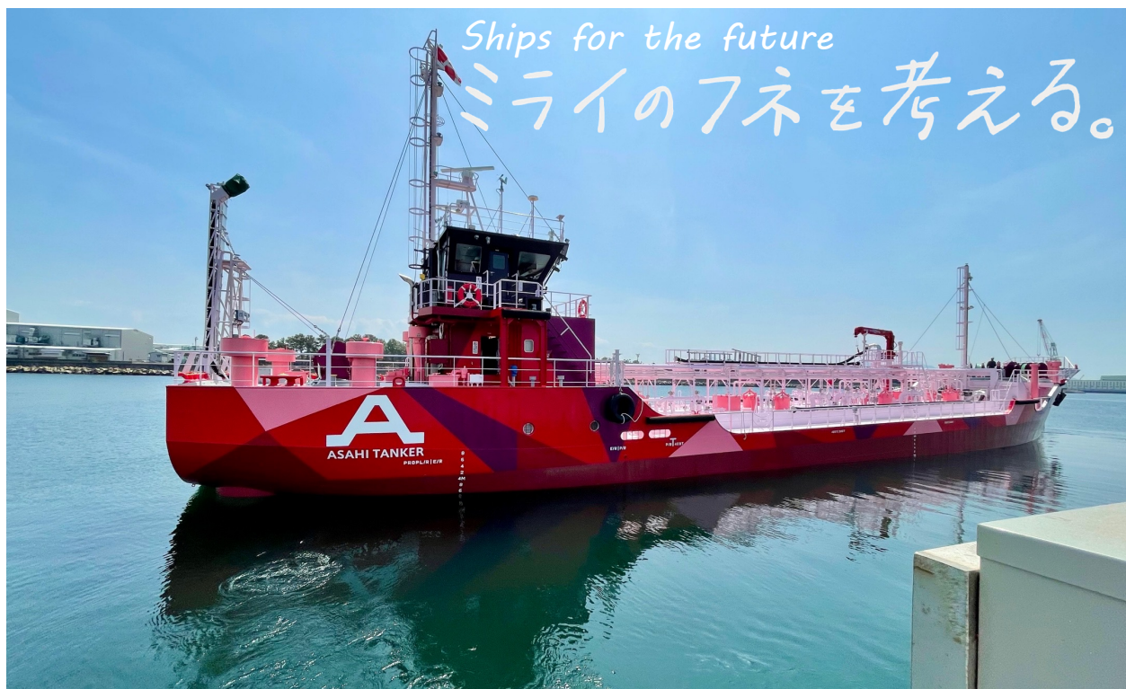
写真1：ジョイスティックにより並行に岸壁から離棧するEVタンカー『あさひ』
